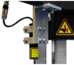
Dispositivo laser per individuazione del taglio
