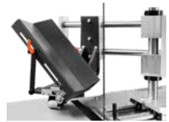
Dispositivo ausiliario per taglio radiale
