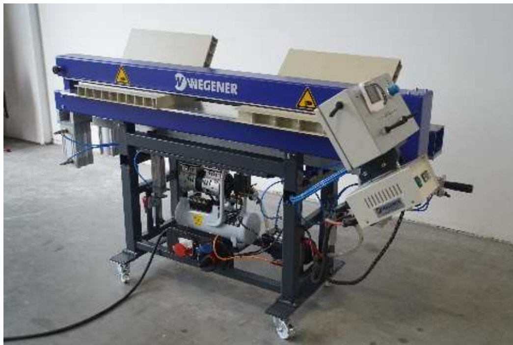
Dispositivo per saldatura pannelli in vari angoli
